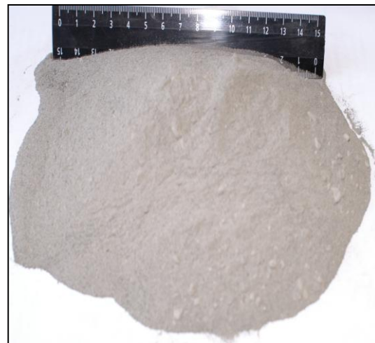
Алюмосиликатный продукт Сод. С = 0,6-2,0 % Для производства строительных материалов
